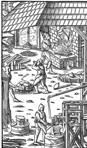
Der Herd A. Der Beschickungshaufen B. Der Schlackenabfluß C. Der Eisenklumpen (Masse) D. Die Holzhämmer E. Der große eiserne Hammer F. Der Amboss G.
